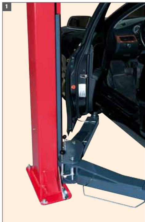
**1. Azionamento con cilindri in trazione e con circuito master/slave.**
